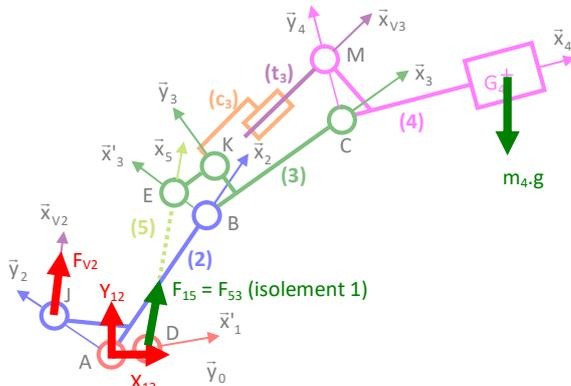
TMS en A/ z0 :  $(\vec{AG}_4 \wedge -m_4 \cdot g \cdot \vec{y}_0 + \vec{AD} \wedge F_{15} \cdot \vec{x}_5 + \vec{AJ} \wedge F_{V2} \cdot \vec{x}_{V2}) \cdot \vec{z}_0 = 0$
