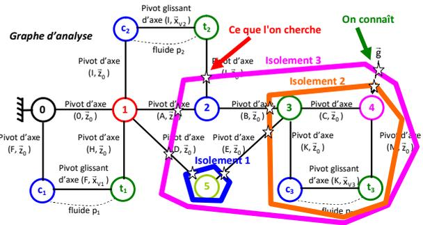
**Q.9. On isole l'ensemble E1 = 3+4+V3 + BAME**. On applique le PFS sur l'ensemble E1.
