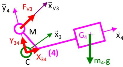
TMS en C/ z0 :  $(\vec{CG}_4 \wedge -m_4 \cdot g \cdot \vec{y}_0 + \vec{CM} \wedge F_{V3} \cdot \vec{x}_{V3}) \cdot \vec{z}_0 = 0$
