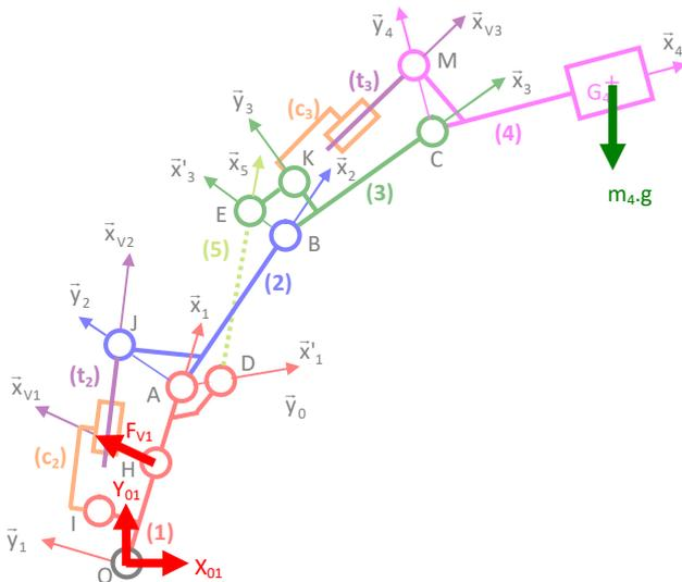
TMS en O/ z0 :  $(\vec{OG}_4 \wedge -m_4 \cdot g \cdot \vec{y}_0 + \vec{OH} \wedge F_{V1} \cdot \vec{x}_{V1}) \cdot \vec{z}_0 = 0$
