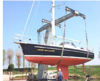
La console 1 est en liaison avec le quai 0 par l'intermédiaire d'une liaison rotule de centre A et d'une liaison linéaire annulaire en B(0,0,z<sub>B</sub>) d'axe (B, z̄). Cette solution permet de faire pivoter la console autour de l'axe (B, z̄) à l'aide d'un vérin linéaire dont la tige est rattachée au point C(0,-y<sub>C</sub>,z<sub>C</sub>). Le vérin fonctionne uniquement lors de la mise à l'eau du bateau.
