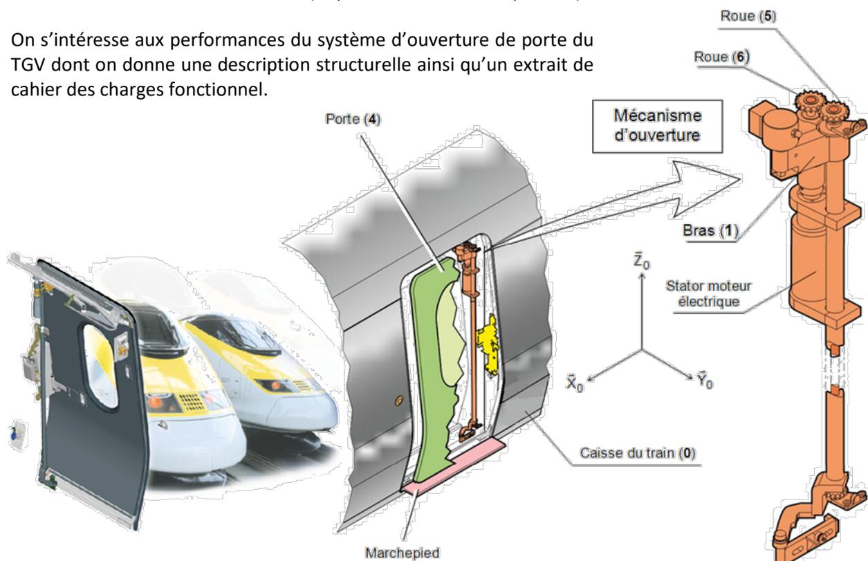
Afin de satisfaire les contraintes d'encombrement, l'ouverture de la porte s'effectue selon l'enchaînement temporel de trois phases distinctes décrites à partir de la position « porte fermée » pour laquelle la face extérieure de la porte est alignée avec la face extérieure de la caisse : une phase de décalage puis une phase de louvoisement et enfin une phase d'escamotage. La phase primaire (décalage) puis la phase terminale (escamotage) sont définies par les figures en vue de dessus ci-contre.
