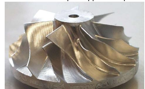
Exemple de pièce complexe obtenue par usinage
