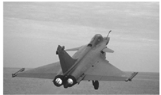
Avion de combat Rafale propulsé par deux moteurs Snecma M88
