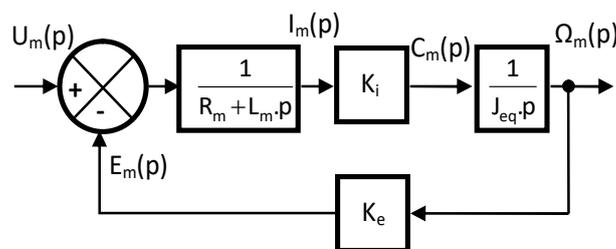
**Q.6. et Q.7. Fonction de transfert boucle fermée du moteur**
