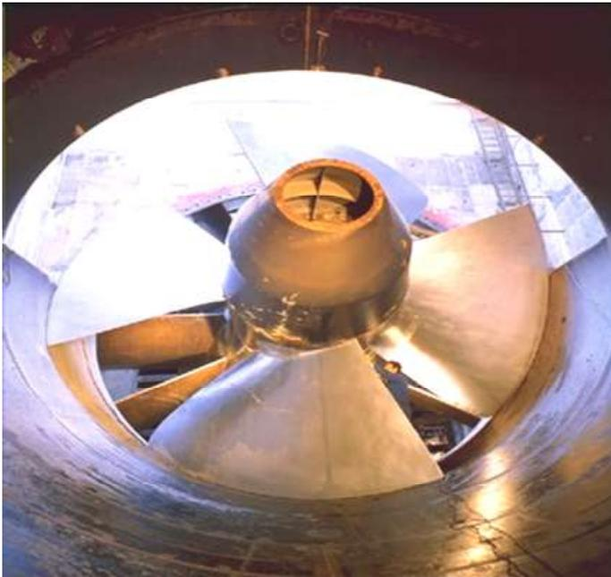
Turbine bulbe de basse chute ALSTOM
