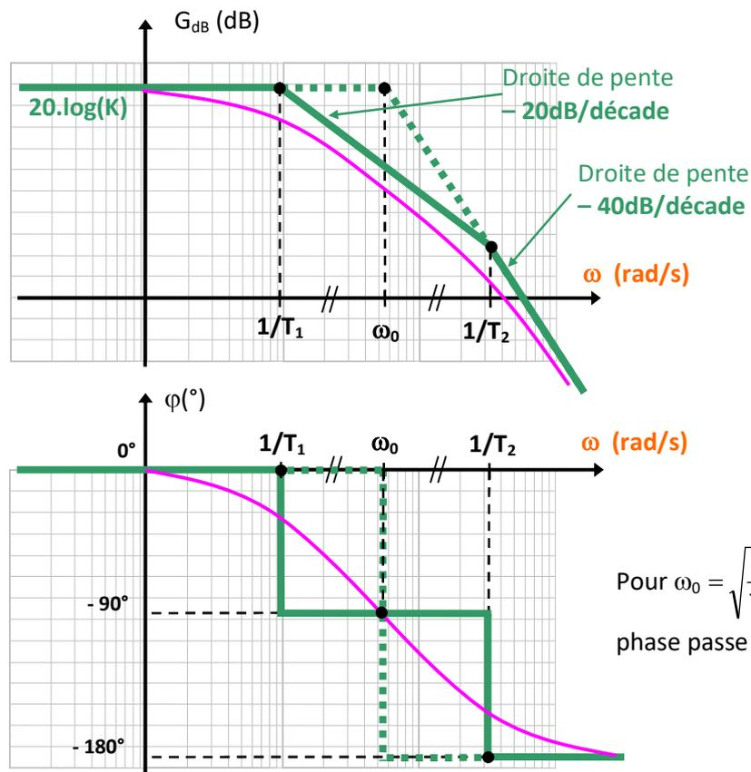
Pour  $\omega_0 = \sqrt{\frac{1}{T_1 \cdot T_2}}$  la courbe de phase passe toujours par  $-90^\circ$ .
