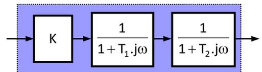
Pour  $z = 1$ , la fonction de transfert devient un carré parfait :  $H(j\omega) = \frac{K}{(1 + T \cdot j\omega)^2}$  avec
