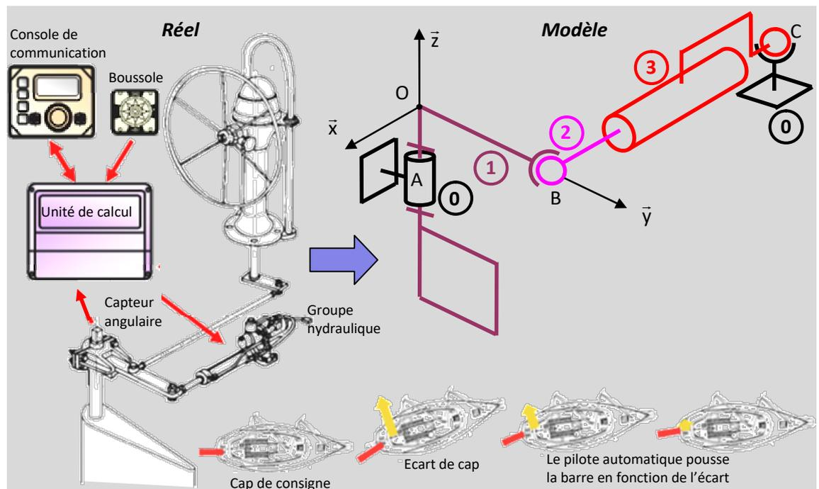
On s'intéresse à un pilote automatique de voilier qui permet d'ajuster automatiquement le cap d'un bateau sans l'intervention du marin. L'ensemble gouvernail barre franche, repéré 1, est en liaison pivot d'axe  $(A, \vec{z})$  par rapport au voilier repéré 0. Lorsque le pilotage est automatique, l'ensemble gouvernail barre franche est actionné par un vérin linéaire repéré (2+3).
