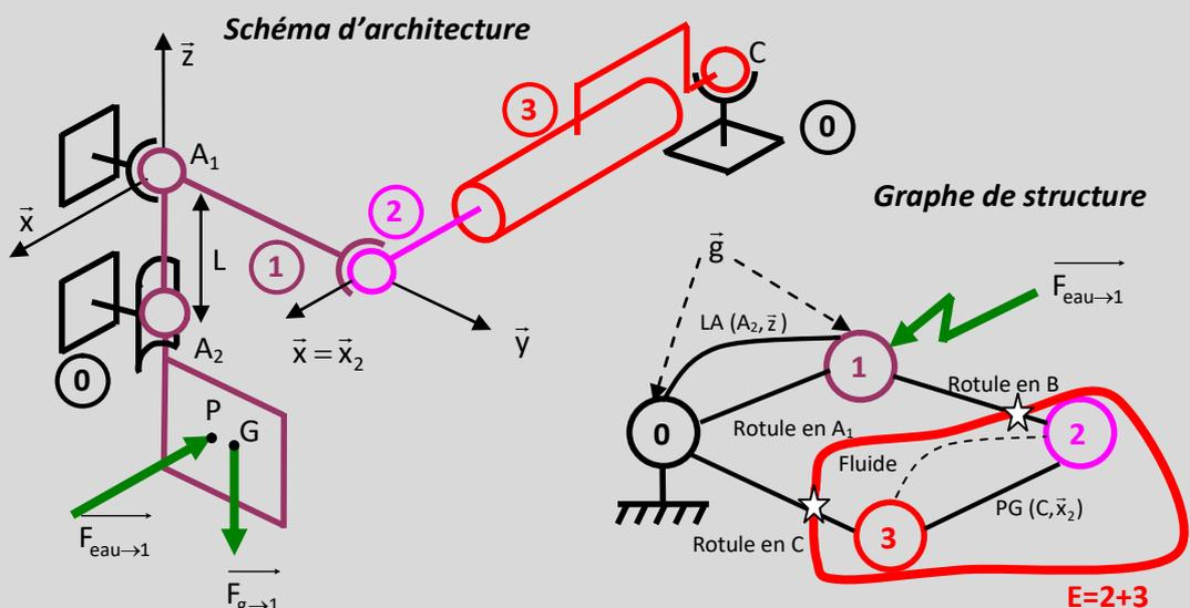
On réalise dans un 1<sup>er</sup> temps le bilan complet des actions mécaniques agissant sur le pilote automatique. On ajoute ces données sur le graphe d'analyse et éventuellement sur le schéma d'architecture :
