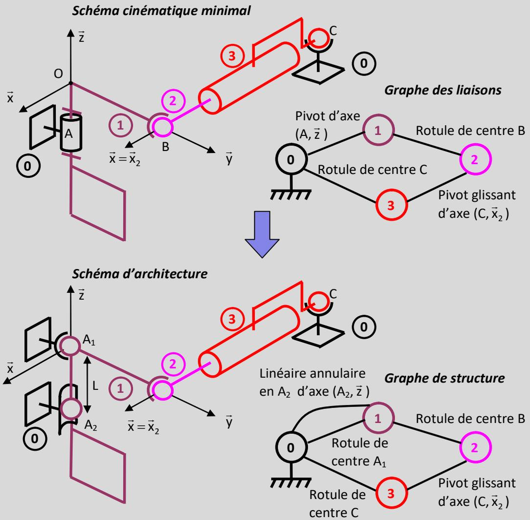
Le schéma d'architecture est aussi un modèle mais il s'approche davantage du système réel en tenant compte des solutions technologiques utilisées pour réaliser les liaisons.
